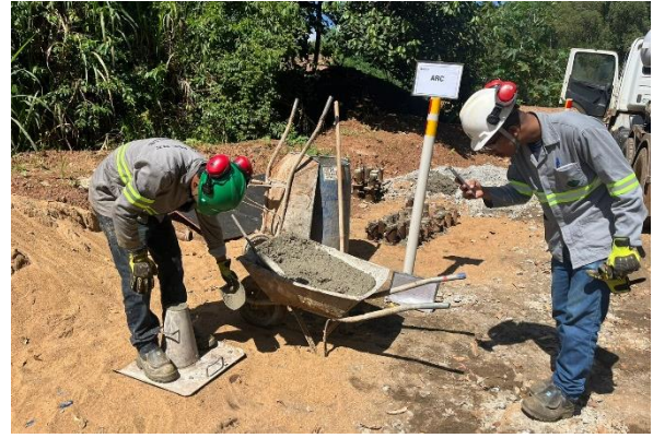
Figura 91 – Controle de qualidade realizado pela fiscalização – Ensaio de “slump test” realizado em concreto.
