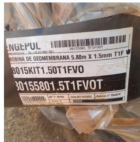
Figura 56 – Recebimento de geomembrana em campo, armazenamento e conferência de especificações.
