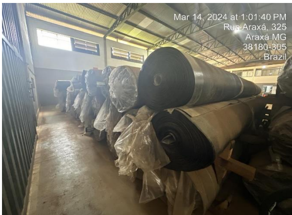
Figura 55 – Inspeção em local de armazenamento da geomembrana para verificação das condições antes do recebimento do material na obra.
