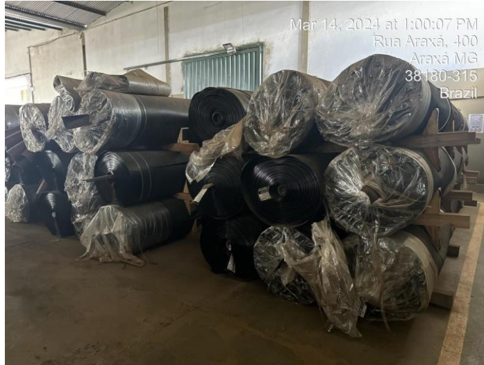
Figura 54 – Inspeção em área de armazenamento da geomembrana para verificação das condições antes do recebimento do material na obra.
