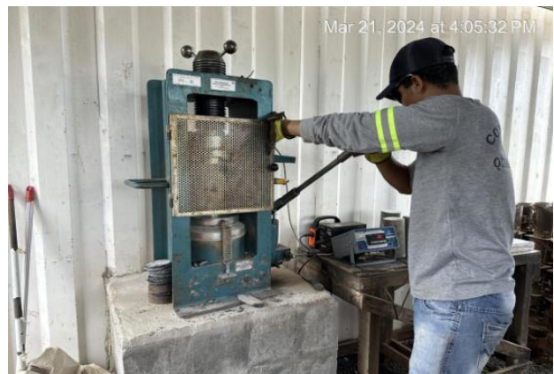
Figura 92 – Controle de qualidade realizado pela fiscalização – Ensaio de resistência à compressão de corpos de prova.
