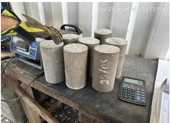
Figura 92 – Controle de qualidade realizado pela fiscalização – Ensaio de resistência à compressão de corpos de prova.
