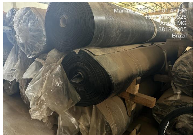
Figura 55 – Inspeção em local de armazenamento da geomembrana para verificação das condições antes do recebimento do material na obra.
