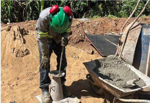
Figura 91 – Controle de qualidade realizado pela fiscalização – Ensaio de “slump test” realizado em concreto.
