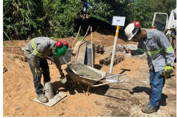
Figura 125 – Controle de qualidade realizado pela fiscalização – Ensaio de “slump test” realizado em concreto.
