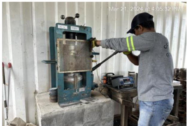
Figura 127 – Controle de qualidade realizado pela fiscalização – Ensaio de resistência à compressão de corpos de prova.
