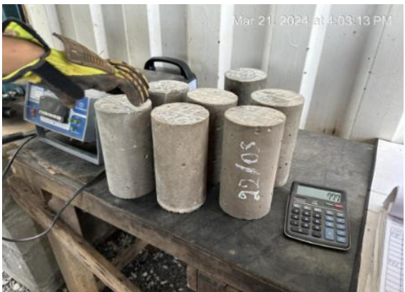
Figura 127 – Controle de qualidade realizado pela fiscalização – Ensaio de resistência à compressão de corpos de prova.
