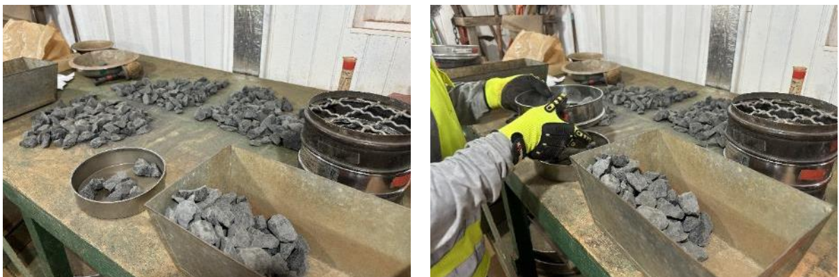
Figura 124 – Controle de qualidade e especificações realizado pela fiscalização – Ensaio de granulometria no enrocamento recebido.
