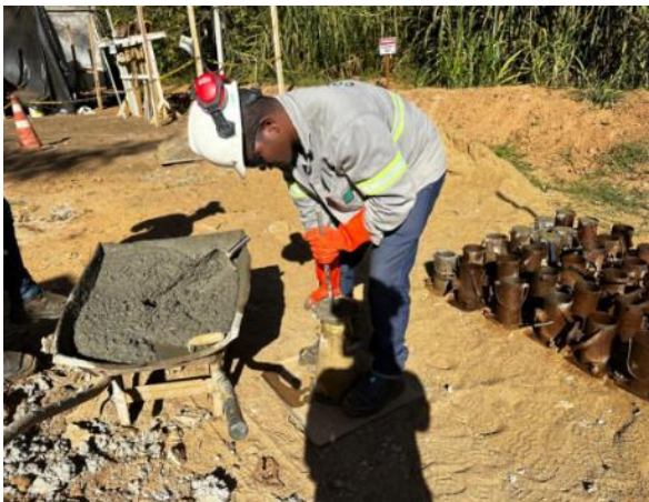
Figura 126 – Controle de qualidade realizado pela fiscalização – Ensaio de “slump test” realizado em concreto e moldagem de corpos de prova para ensaios mecânicos.
