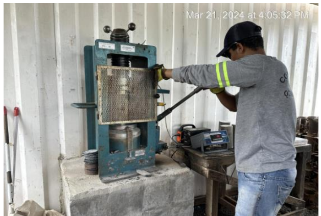
Figura 42 – Controle de qualidade realizado pela fiscalização – Ensaio de resistência à compressão de corpos de prova.
