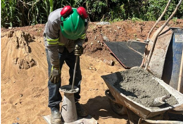
Figura 40 – Controle de qualidade realizado pela fiscalização – Ensaio de “slump test” realizado em concreto.
