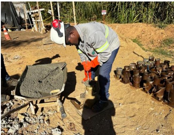
Figura 41 – Controle de qualidade realizado pela fiscalização – Ensaio de “slump test” realizado em concreto e moldagem de corpos de prova para ensaios mecânicos.
