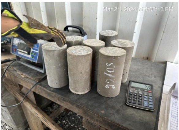
Figura 42 – Controle de qualidade realizado pela fiscalização – Ensaio de resistência à compressão de corpos de prova.
