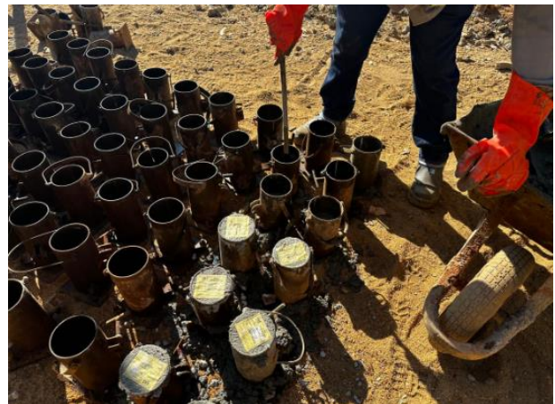
Figura 41 – Controle de qualidade realizado pela fiscalização – Ensaio de “slump test” realizado em concreto e moldagem de corpos de prova para ensaios mecânicos.
