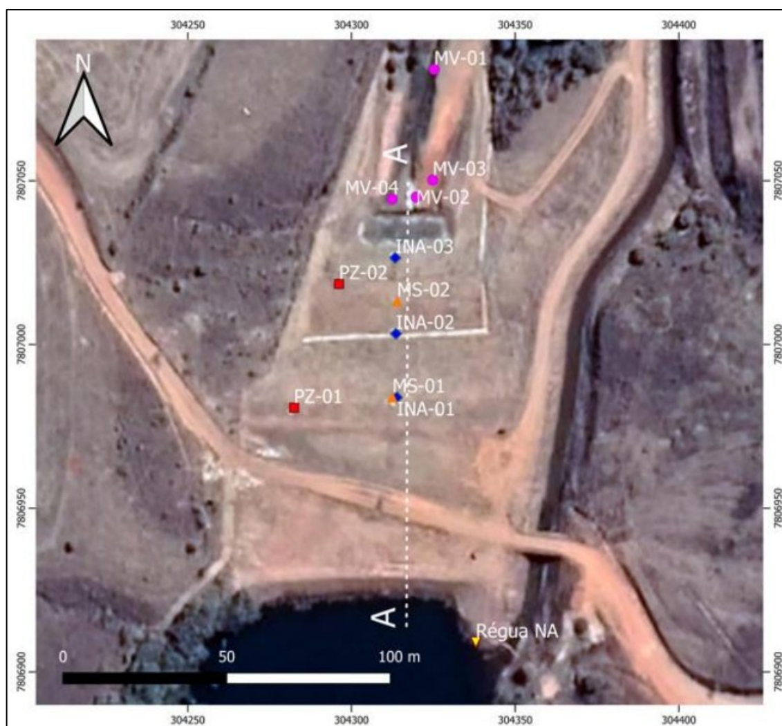
Figura 11.1 - Localização dos instrumentos existentes na Barragem BA3 (WA00821014-1-GT-RTE-0019).
