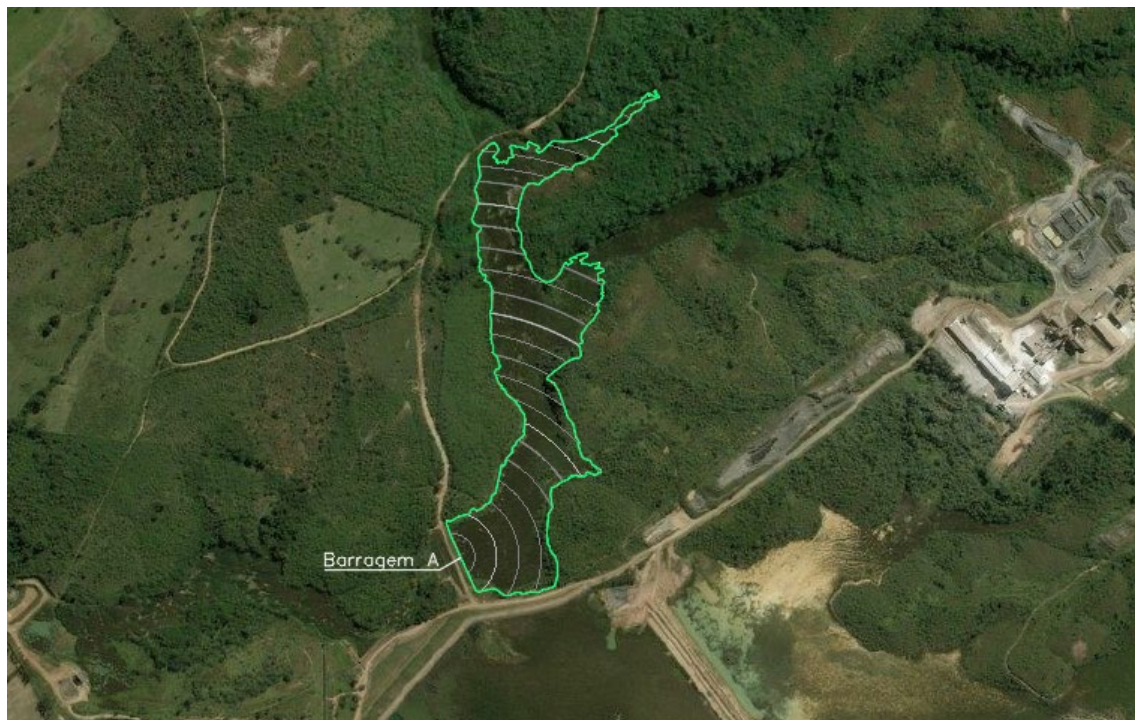
Figura 10.6 - Parcela de rejeito mobilizado – Barragem A.
