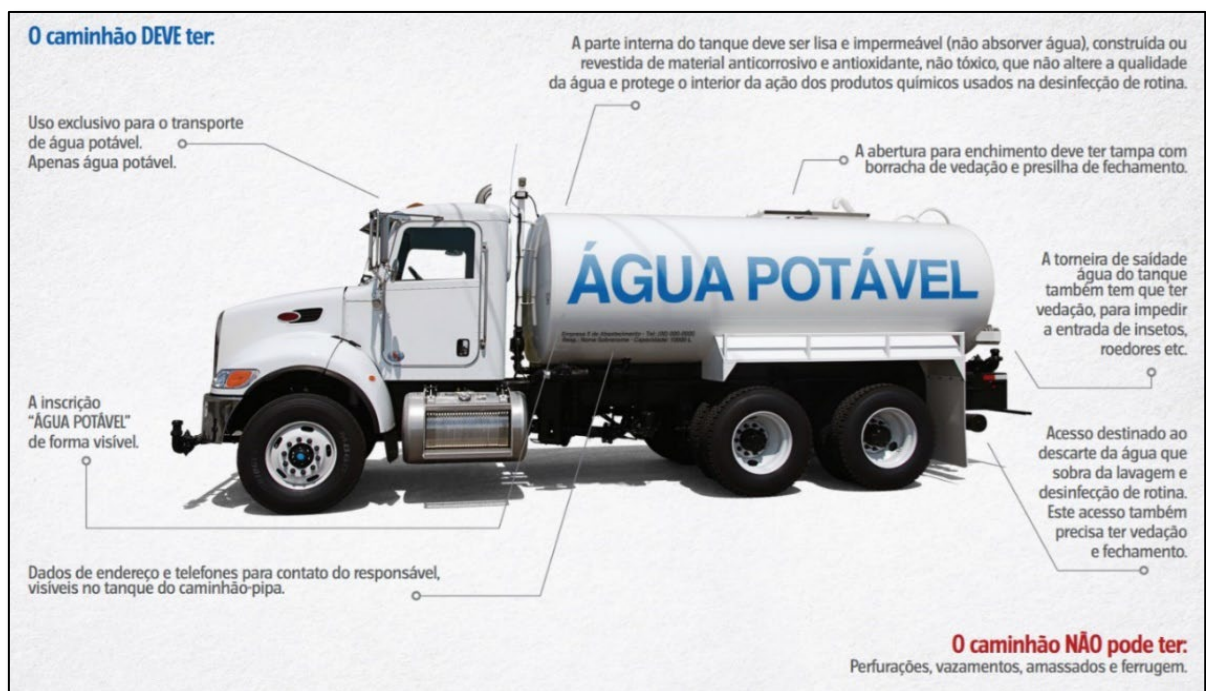
Figura 18-8 - características do veículo transportador de água para consumo humano Fonte: Cartilha “Pequenos cuidados: uma grande proteção” (BRASIL, 201?).
